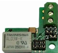
9135250E Zusätzlicher Relaiskontakt Offen / Geschlossen Option , zeitlich unbegrenzt bis 48V/ 2A.
