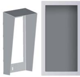
Art.-Nr. 9135361E Einlassrahmen UP mit Rahmen für ein Modul Rahmen-Dimensionen (lxbxh) : 129 x 240 x 41 mm Wandaussparung (lxbxh): 110 x 220 x 50mm +- 5mm
