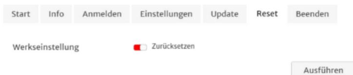
Nach Ausführung des Resets, bitte zuerst die Applikation mit "Beenden" verlassen und danach die USB Stecker kurz aus- und wieder einstecken. Die mittlere LED blinkt dann nach erfolgreichem Reset rot.
